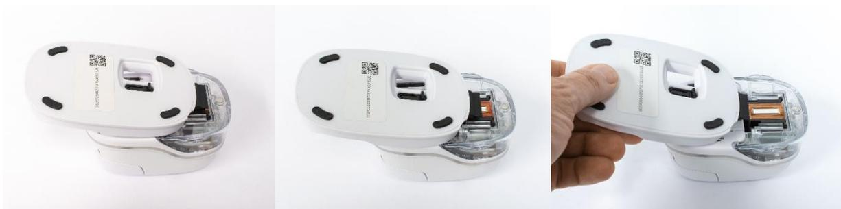
Fig. 20 : Passer le nettoyeur sur la tête d'impression
