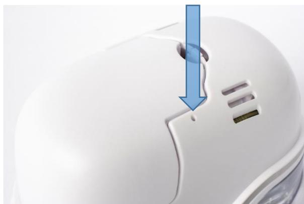
Fig. 37 : Ouverture pour réinitialiser l'appareil (reset)
