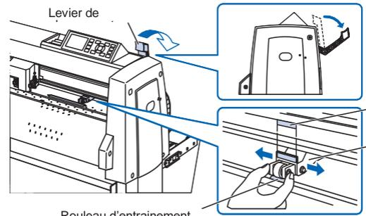
Pour les modèles avec quatre galets ou plus, répartissez les galets intermédiaires sur la largeur correspondante aux rouleaux d'entraînement.
