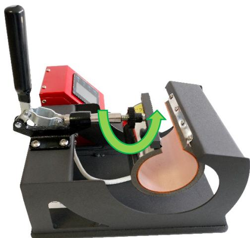
Tourner la vis de réglage de la pression dans le sens inverse des aiguilles d'une montre pour augmenter la pression
