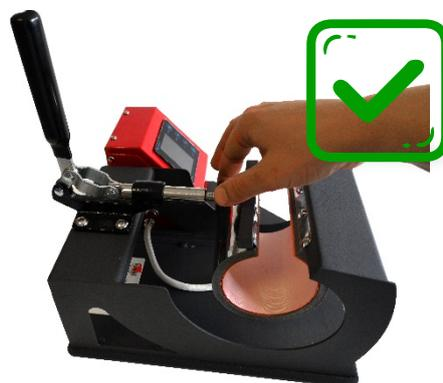
Tourner la vis de réglage de la pression dans le sens des aiguilles d'une montre pour diminuer la pression
