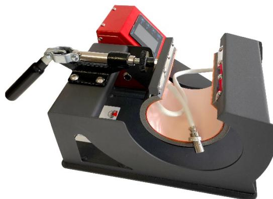
Acheminez soigneusement le câble jusqu'au connecteur, en prenant soin de le tenir à l'écart de toutes les pièces mobiles.
