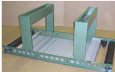
Installez ensuite les pieds fournis avec le tunnel et le capot de protection de la chaîne avant de brancher le tunnel
