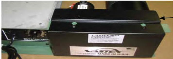
Pour retirer le capot dévisser les 2 vis placés au dessus. N'oubliez pas de remettre en place le cache à la fin de l'intervention et avant de remettre en marche le tunnel.
