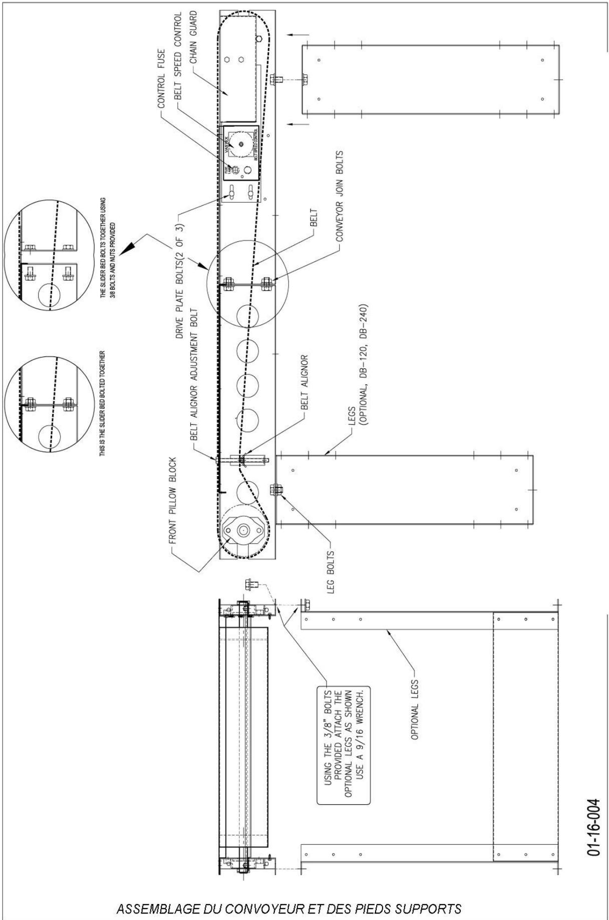
ASSEMBLAGE DU CONVOYEUR ET DES PIEDS SUPPORTS
