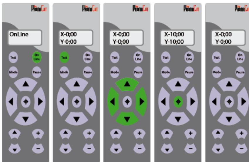
Echeniller le test de découpe, si la découpe est mauvaise ajuster la force (voir paragraphe suivant) et refaire un test de découpe. Une fois le test de découpe est bon, Passer le plotter en mode OnLine.
