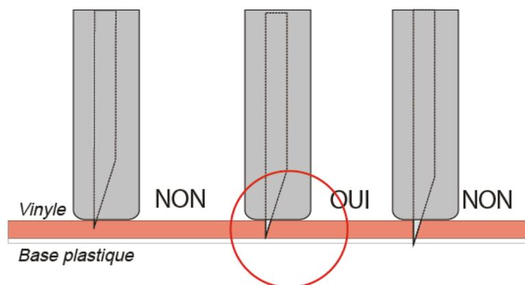
Seule une petite partie de la lame doit dépasser du porte-lame. Ce dépassement ne doit pas excéder l'épaisseur totale du vinyle à découper + son liner. Il est important de respecter cette précaution pour ne pas user prématurément les lames.
