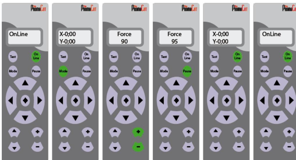
Pour prolonger la durée de vie de la bande téflon, sélectionnez la FORCE la plus faible et ajuster-la petit à petit en vérifiant que le tracé soit lisible.
