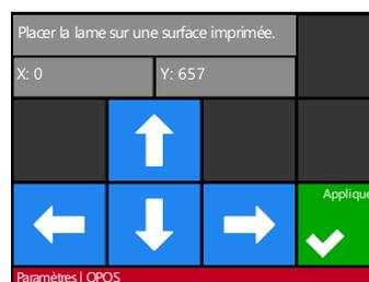
8. Utilisez les flèches pour déplacer la lame au milieu de la zone imprimée ; appuyez sur Appliquer
