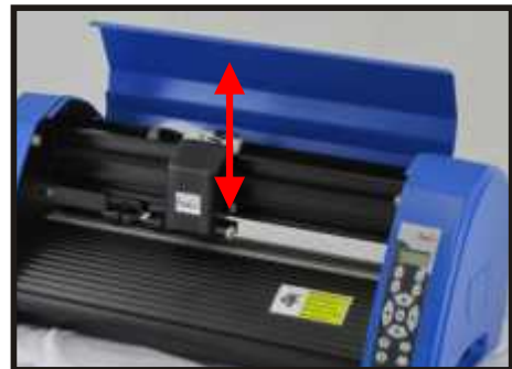
Ouvrir le capot pour installer le porte-lame
