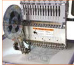
L'accessoire **Sequin collé** combiné au Pantographe permet la réalisation de logos en sequin thermocollant.
