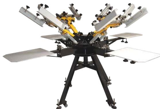
Le **ProSP 4-4** est un carrousel sur pied avec 4 têtes d'impression. Très stable, il est dédié aux professionnels du marquage qui souhaitent développer leurs capacités de production. Robuste et simple d'utilisation, ce carrousel possède un double moyeu rotatif avec roulements à billes auto-graissés.
