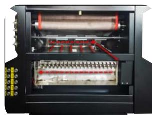
Dépose et recyclage de la poudre automatique
