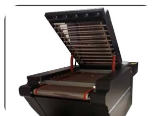
Séchage uniforme garanti grâce aux 10 tubes chauffants
