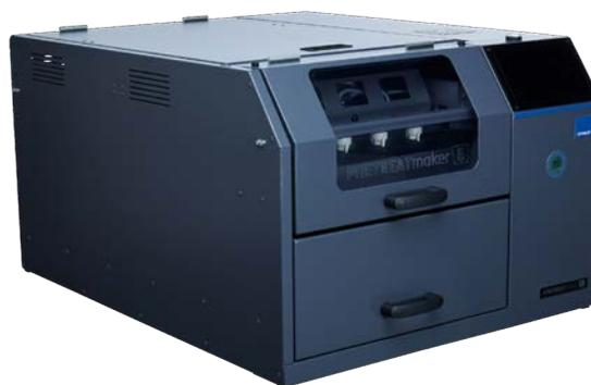
Les Pretreatmaker V sont équipées de 5 buses de pulvérisation qui peuvent être activées ou désactivées individuellement. La surface de pulvérisation maximale de 42 x 60 cm pour la Maker V et de 63 x 63 cm pour la Maker V Max qui peut être ajustée selon la surface à traiter. Les Maker V disposent de plusieurs fonctionnalités automatiques pour définir les zones et les quantités à pré traiter. Grâce à ses fonctionnalités automatiques, l'économie de liquide peut atteindre 30% selon les productions.
