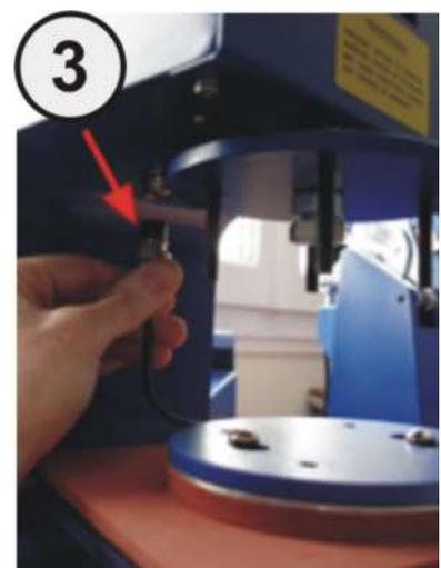
**4/** Positionnez le nouveau plateau chauffant sur le plateau inférieur et mettez les 4 ressorts au-dessus des trous filetés dans lesquelles viendront se positionner les 4 vis de fixation. Branchez le raccord électrique du nouveau plateau.
