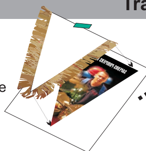
Placement du fanion sur le transfert avec le scotch haute température
