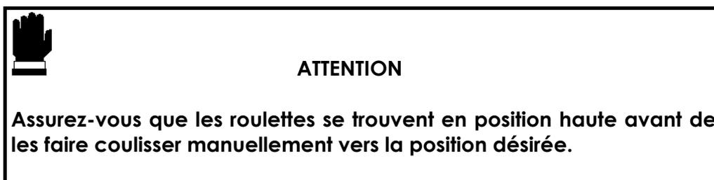
Les roulettes DOIVENT être positionnées correctement et abaissées sur le support avant que vous ne démarriez le chargement à partir du panneau de commande. Assurez-vous que les deux roulettes sont bien placées au-dessus des manchons d'entraînement. Les manchons d'entraînement ne déplacent le support que si les roulettes sont abaissées sur les manchons.
