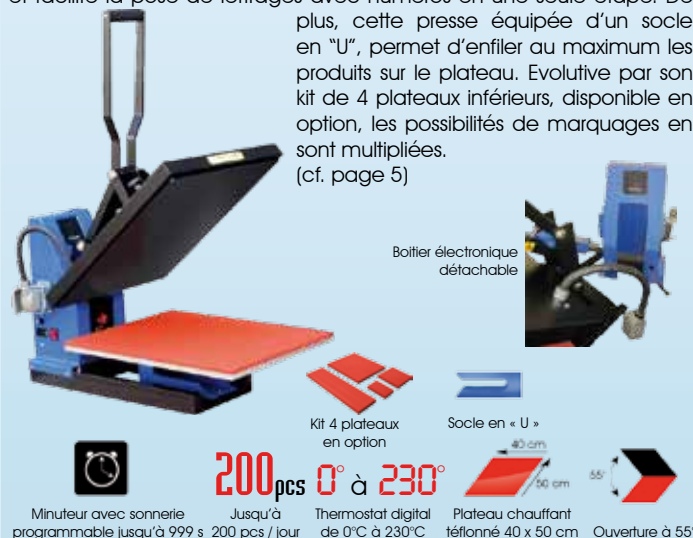
Minuteur avec sonnerie programmable jusqu'à 999 s / Jusqu'à 100 pcs / jour / Thermostat digital de 0°C à 230°C / Plateau chauffant téflonné 38 x 38 cm / Ouverture à 85°
