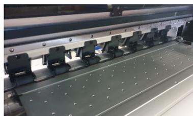
Rampe chauffante pour la fixation des encres en surface
