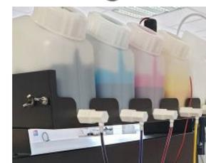
Système d'encrage en continu en réservoir de 1 litre
