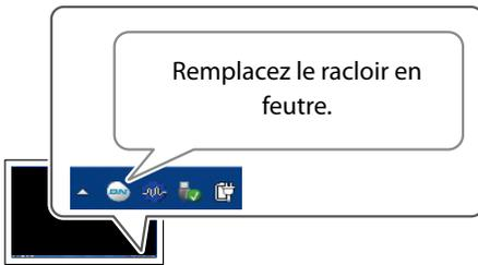
Le racloir en feutre sert au nettoyage des têtes d'impression. Quand le message illustré apparaît sur l'icône "Utility" de la barre des tâches, il est temps de remplacer le racloir par un nouveau.
