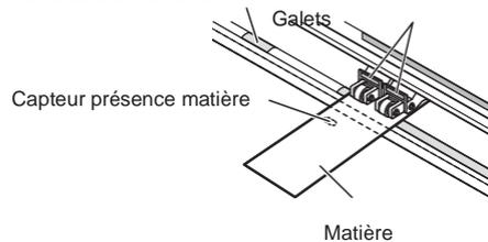
Pour les modèles CE7000-130/160, utilisez les deux galets les plus à droite et réglez "MENU" - "AVANCE" - "LARGEUR DU MEDIA" sur "ETROIT".
