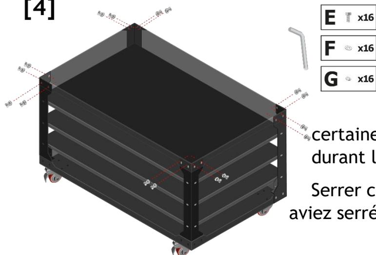
Tourner quelques fois les vis indiquées sur l'illustration afin de les maintenir en place temporairement. Serrer trop fort les vis pourrait empêcher certaines pièces de s'emboîter correctement durant le montage de la table.
