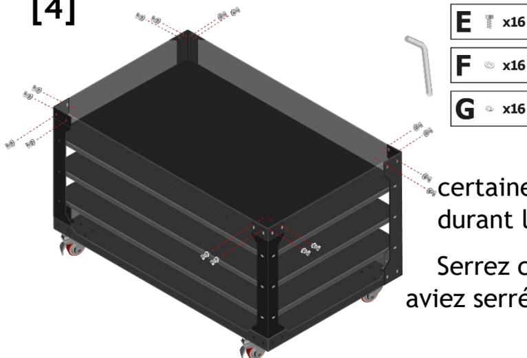
Tournez quelques fois les vis indiquées sur l'illustration afin de les maintenir en place temporairement. Serrer trop fort les vis pourrait empêcher certaines pièces de s'emboîter correctement durant le montage de la table.
