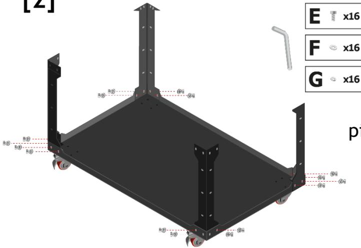
Tournez quelques fois les vis indiquées sur l'illustration afin de les maintenir en place temporairement. Serrer trop fort les vis pourrait empêcher certaines pièces de s'emboîter correctement durant le montage de la table.
