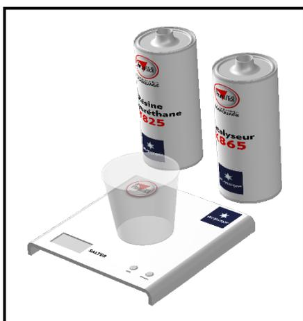
Allumez la balance, posez le gobelet jetable percée dessus et appuyer sur le bouton « on-zero »
