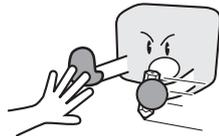
Lorsque vous utilisez l'éclairage intérieur, comme les lampes fluorescentes ou autres électriques, prévoir une distance d'au moins un mètre entre le traceur et la source de lumière.
