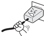
Si de l'eau ou une matière étrangère pénètre dans le traceur, cessez l'utilisation. Coupez l'alimentation et débranchez le cordon d'alimentation de la prise électrique.
