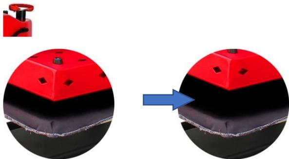
Tourner la poignée réglage pression dans le sens des aiguilles d'une montre afin de descendre le plateau chauffant
