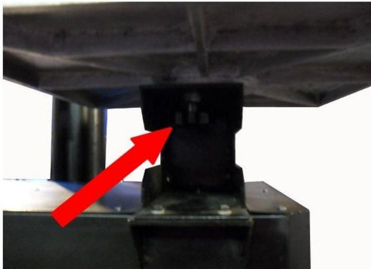
Une fois le plateau d'origine retiré, placez le nouveau plateau sur la presse. L'orifice central situé sur le socle est réservé à la vis de fixation. Les deux autres orifices sont destinés au téton (tête de vis fixée sous le plateau) qui vient assurer un bon maintien du plateau. Positionnez ce téton sur l'orifice du haut ou de gauche en fonction de l'orientation de plateau dont vous avez besoin.
