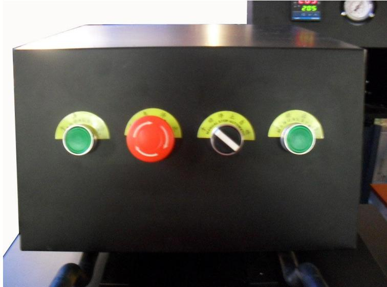
1 – Mettre le bouton sélecteur **(9)** de mode sur la position « **Manuel** », amenez le plateau chauffant à l'aide de la poignée **(10)** sur le plateau inférieur **(12)** désiré,
