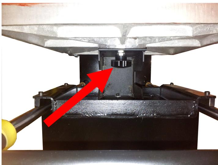
Une fois le plateau d'origine retiré, placez la calle puis le nouveau plateau sur la presse. L'orifice central situé sur le socle est réservé à la vis de fixation. Les deux autres orifices sont destinés au téton (tête de vis fixée sous le plateau) qui vient assurer un bon maintien du plateau. Positionnez ce téton sur l'orifice du haut ou de gauche en fonction de l'orientation de plateau dont vous avez besoin.
