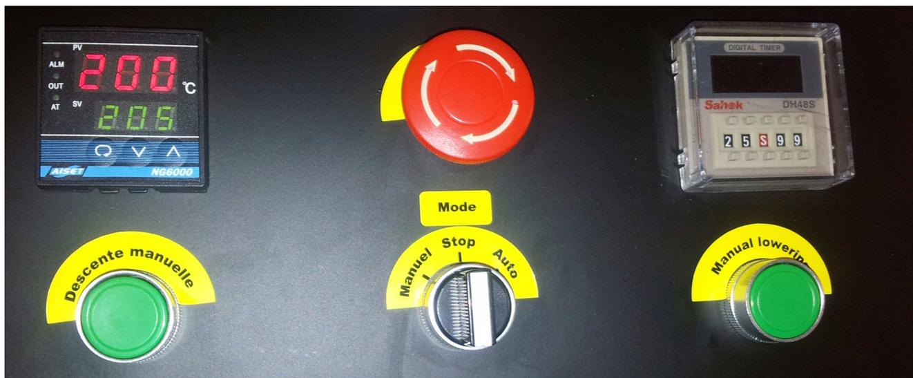
**A** – Mettre le bouton sélecteur de mode sur la position << **Manuel**>>, poussez le plateau inférieur à l'aide de la poignée sous le plateau chauffant,
