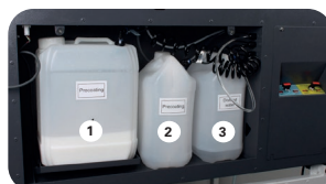
3 réservoirs embarqués et intégrés à la machine 1 : liquide de prétraitement 2 : liquide de prétraitement (possibilité d'utilisation d'un autre type de liquide) 3 : eau déminéralisée ou solution de nettoyage pour les opérations de maintenance.
