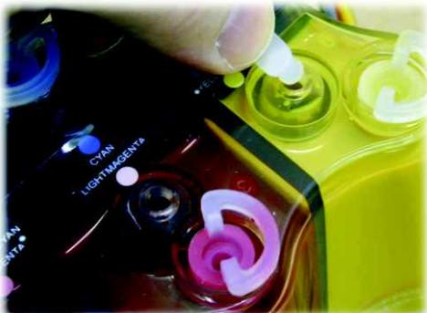
A l'aide de la seringue et de l'aiguille, aspirez l'encre placée dans la chambre centrale par le petit orifice du réservoir.
