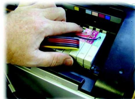
Retirez le scotch du support de tuyaux et placez le comme indiqué sur la photo. Alignez les tuyaux avec les cartouches (dans le sens d'impression).
