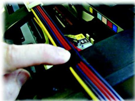
Des bulles d'air peuvent apparaître dans les tuyaux lors de l'installation du système. Lors de l'amorçage, l'air sera évacué.
