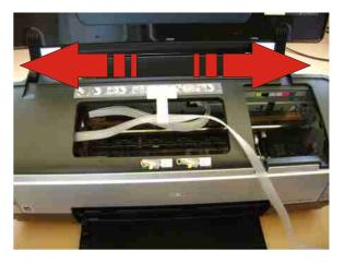
Pousser le chariot à l'extrême gauche pour vérifier le bon positionnement des tuyaux. Ceux-ci ne doivent pas gêner le déplacement du chariot. Réajuster leur position si nécessaire et déplacer plusieurs fois le chariot de droite à gauche pour contrôler.
