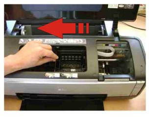
Appuyer sur le bouton des encres pour mettre le chariot en mouvement et débrancher le cordon d'alimentation dès que le chariot bouge.
