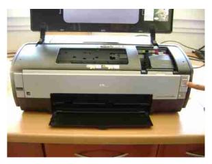
Allumer l'imprimante et appuyer sur le bouton "encre". La chariot vient se placer en position de chargement de cartouche, à droite.
