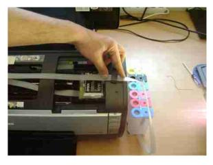
Fixer les tuyaux sur le côté droit de l'imprimante à l'aide d'une pastille de fixation fournie.
