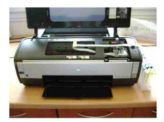
Poser les réservoirs à droite de l'imprimante. Les réservoirs doivent toujours être posés au même niveau que l'imprimante, ne JAMAIS les placer plus haut une fois qu'ils sont remplis.
