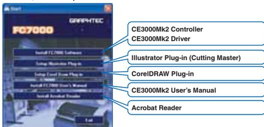
Note: Seul le Driver CE3000Mk2 peut être installé si le système utilise Windows 95 ou NT 4.0.
